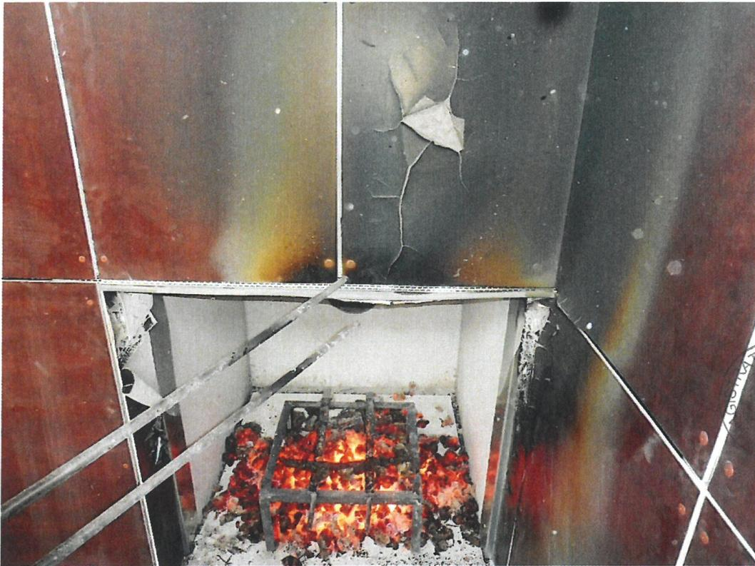
Bild 17 (P1110044): Prüfkörper zum Ende des Brandversuches – Versuchsdauer 30 Minuten
