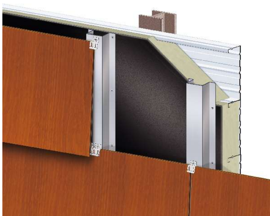
Figure 2bis – Schéma de principe clins avec une membrane de protection des façades bois
