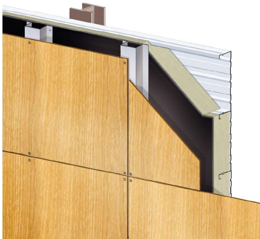
Figure 2 – Schéma de principe panneaux avec une membrane de protection des façades bois
