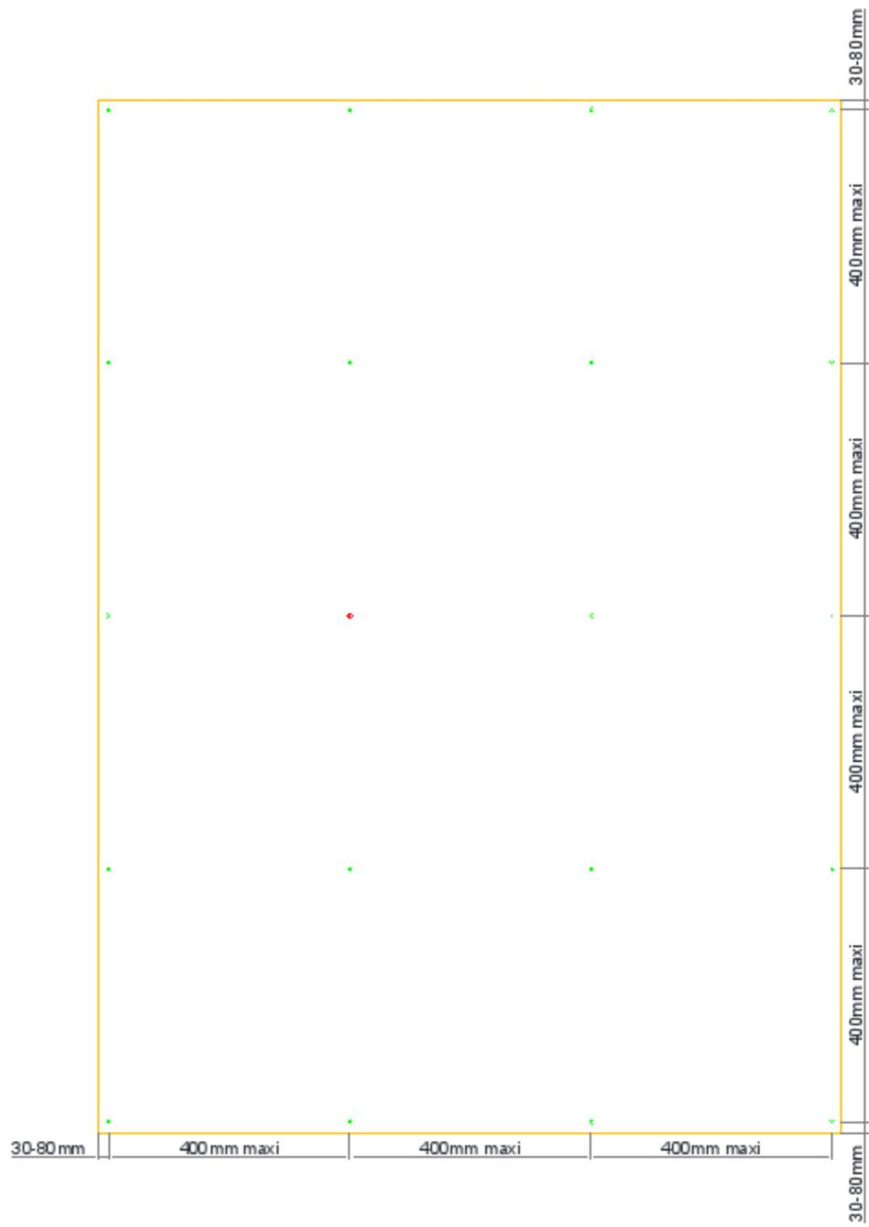
**Figure 19 – Pose en sous-face – Entraxe maxi**
